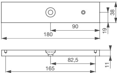
VERROUILLAGES ÉLECTRIQUES Ventouses électromagnétiques en applique série 300 Kg
